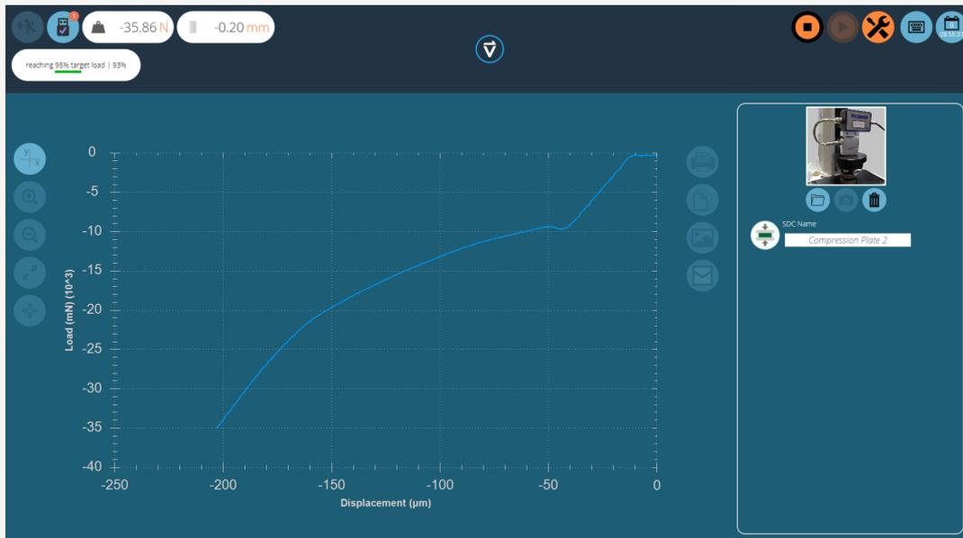
Ahora comenzará la prueba, las dos etapas iniciales (fase de precarga y 90% de ejecución) no se capturan. El estado de la prueba se indica mediante la barra de progreso ubicada en la esquina superior izquierda (en la foto de arriba).
