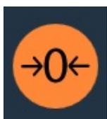
El icono accede a la puesta a cero del valor de desplazamiento, fuerza y extensómetro en el caso de estar instalado.
