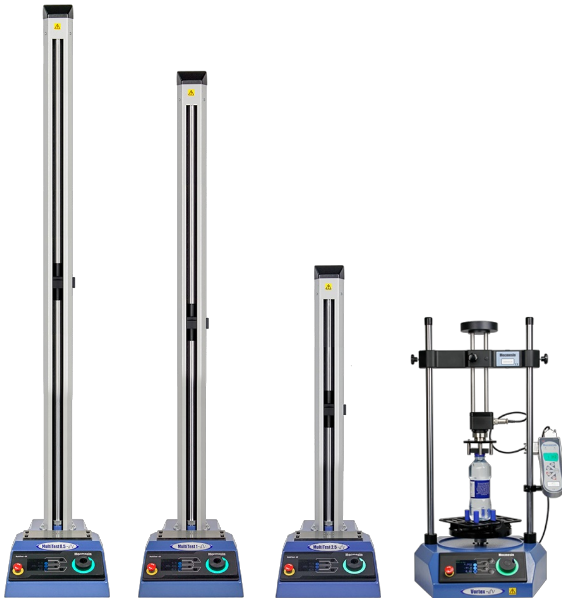
De izquierda a derecha, MultiTest-dV 0.5 kN, MultiTest-dV 1.0 kN, MultiTest-dV 2.5 kN y soporte de ensayos de par modelo Vortex-dV.
