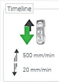
Dentro de VectorPro, cree un nuevo ensayo, seleccione la operación AFG / AFTI (vea la imagen a la derecha, se muestra MultiTest-dV) y asegúrese de que la velocidad y la dirección de inicio coincidan con los ajustes configurados dentro del soporte de ensayos en el paso 2.
