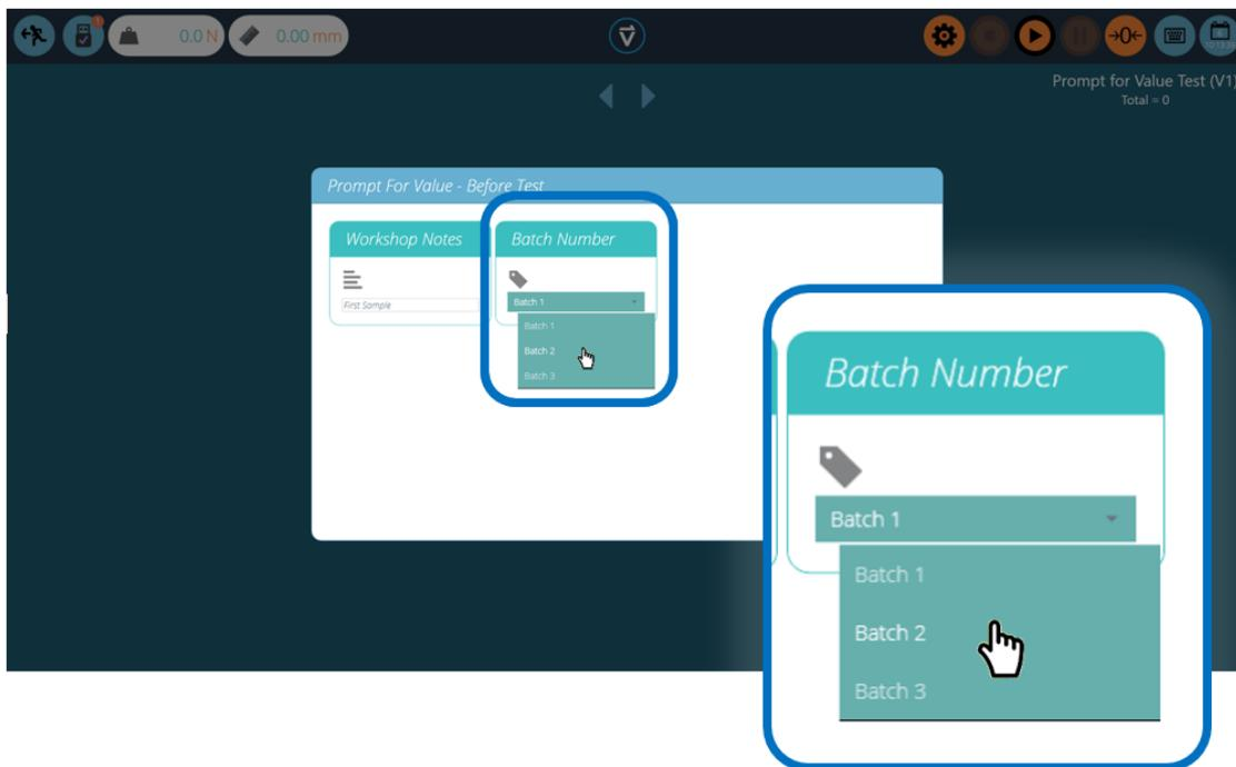
Al comenzar el ensayo, aparece la ventana '**Solicitud de entrada - Antes del Ensayo**'. La entrada está disponible para cualquier característica que se haya configurado para solicitar antes de ejecutar el ensayo.
