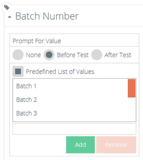
En las imágenes de ejemplo que se muestran arriba y abajo, una característica etiqueta llamada **Número de lote** ' se configura dentro del diseñador de ensayos seleccionando '**Antes del ensayo**' y se introduce una lista predefinida de números de lote.
