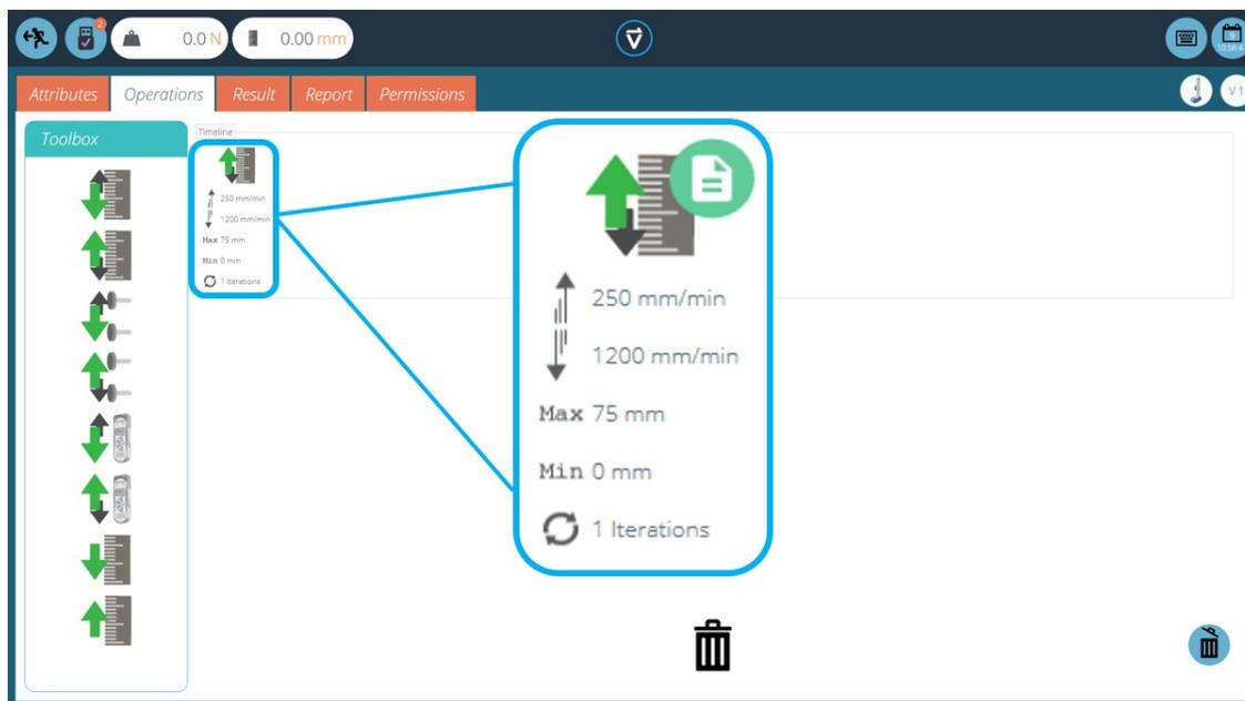
La '**Línea de tiempo**' permite arrastrar y soltar el comando de operación seleccionado desde la '**Caja de herramientas**' de la izquierda para definir la función del ensayo. En este caso, el usuario ha elegido ejecutar un ensayo que consiste en:
