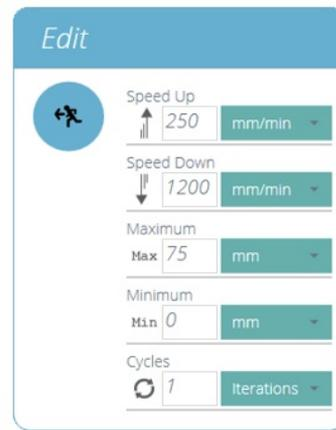
Cada operación tiene parámetros que se pueden editar. Tales como desplazamiento, fuerza, tiempo y velocidad. A continuación se muestra un ejemplo de una ventana de edición de operación; La imagen siguiente muestra un ejemplo de ventana de edición de operación de ensayo; en esta se muestra los controles de desplazamiento y velocidad con sus interacciones.
