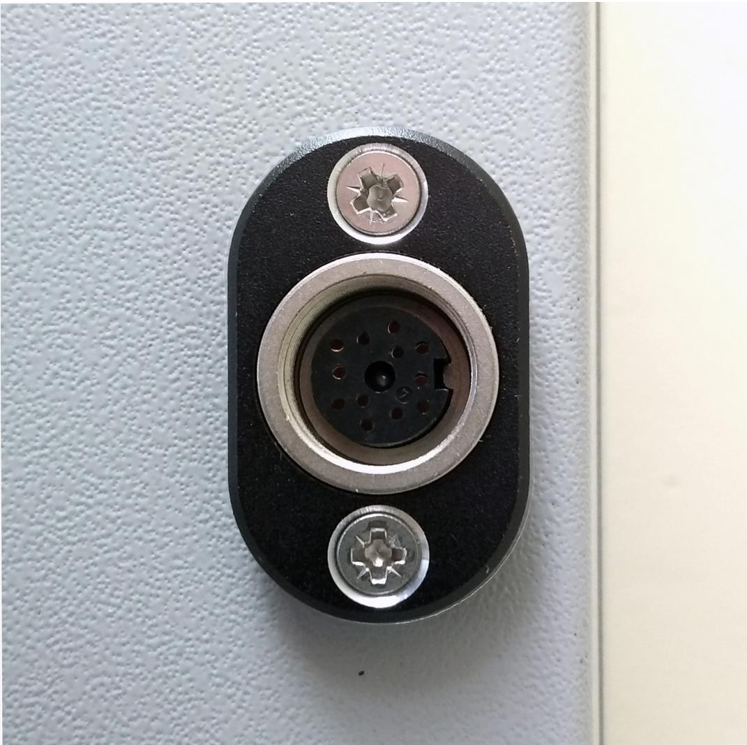
Todos as colunas de teste Mark 2 MultiTest-dV têm uma porta ELS, localizada centralmente na cobertura da coluna no lado direito.
