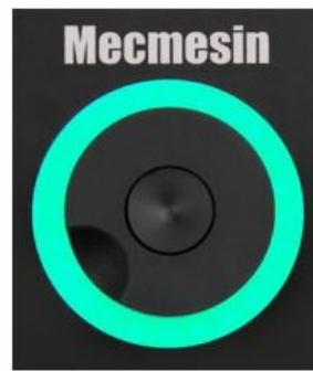
Pressionar o botão '**Play**' avançará a sequência de testes para a próxima operação e, potencialmente, o equipamento começará a mover-se novamente.
