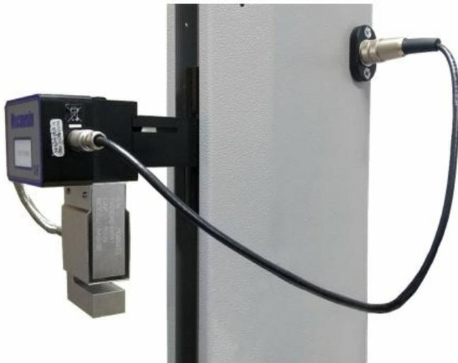
Como os sensores de carga aprimorados são dispositivos '**inteligentes**', todas as informações de calibração e capacidade são passadas para a coluna automaticamente, à medida que o sensor é conectado.
