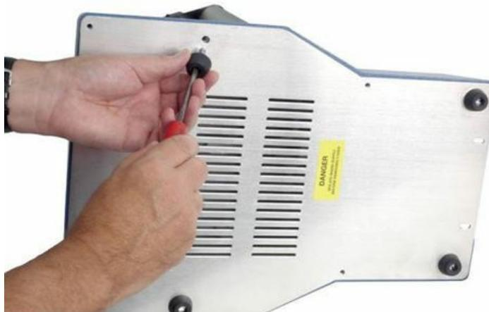
O MultiTest- *dV* 2.5kN é fornecido com quatro pés de borracha. Apoie o suporte e encaixe os quatro pés de borracha na base da coluna usando uma chave de fenda apropriada.
