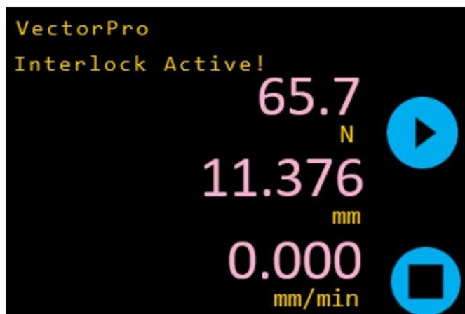
Durante uma operação de '**Pausa**', a seguinte mensagem será exibida no painel frontal do banco de testes ao abrir a proteção; '**Bloqueio ativo!**' Isso é mostrado na imagem acima.
