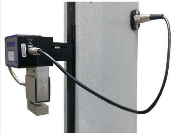
**Observação:** os extensômetros de percurso curto analógico também podem ser atualizados de um método semelhante; conecte o dispositivo extensômetro ao conector correspondente na parte traseira do seu MultiTest- *dV* para atualizar o dispositivo.
