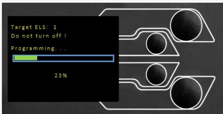
É crucial que a coluna de teste não seja desligada ou desconectada. A desconexão do ELS pode causar danos irreversíveis.
