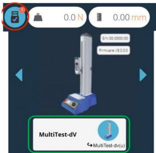
Pressionar o botão, destacado em verde acima, alterna o suporte para o modo *dV(u)*.
