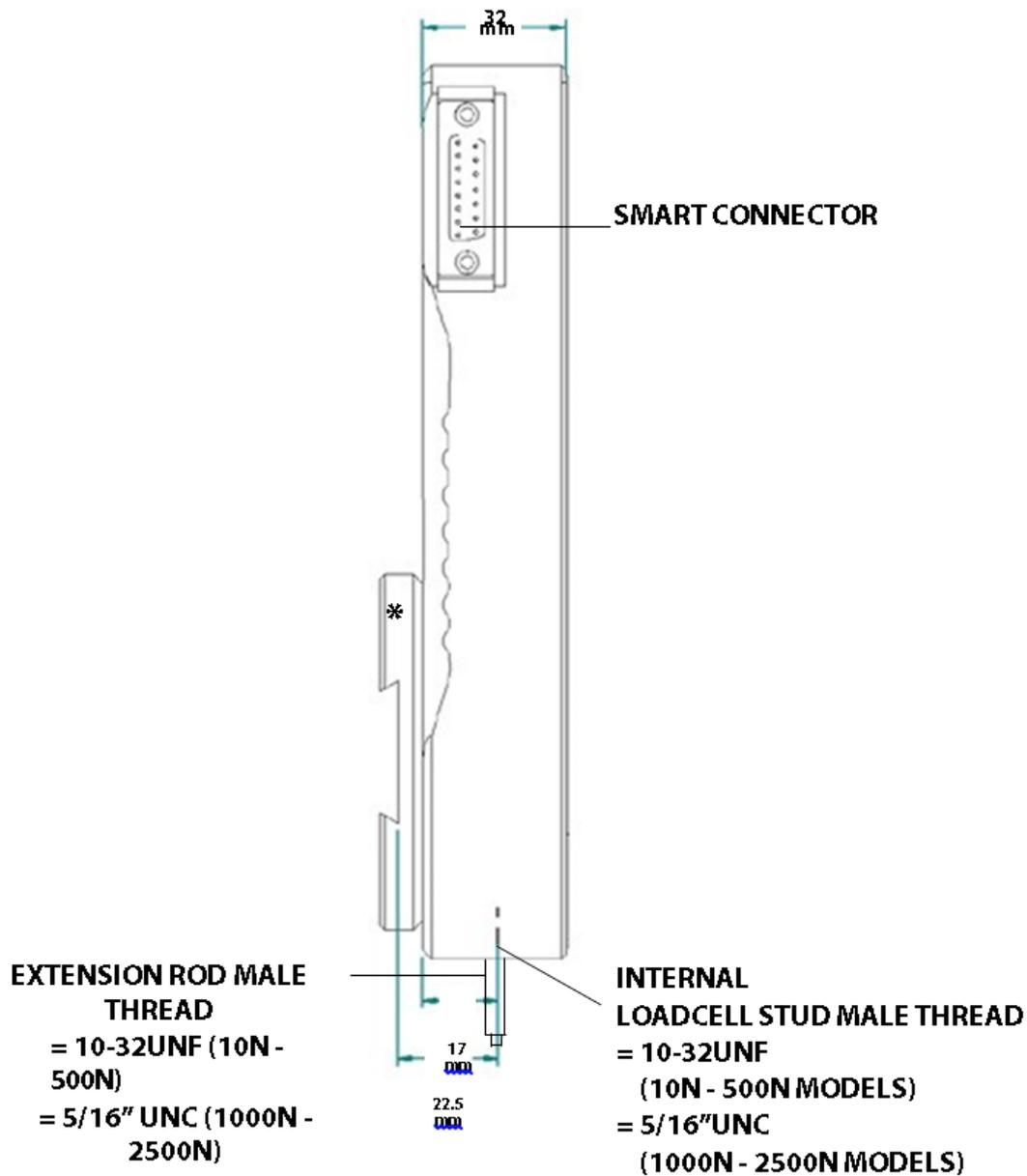
\*図は差し込み取付ブラケット「Mecmesinのテストスタンドへ取り付け」を使用しています
