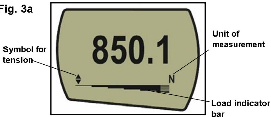
ロードインジケータバーは、ロードセルに加えられた負荷の加減をオペレーターに警告します。負荷がロードセルの最大定格に近づき、定格容量の約80%を超えると、インジケータバーの表示が変化します。これは、過度の負荷がかかることを防ぐために、措置が必要である旨をオペレーターに警告しています。
