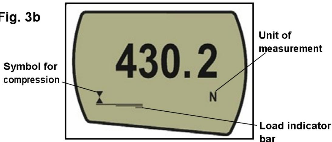
AFGに深刻な過負荷状態が発生した場合、負荷がかかっていない状態でも負荷インジケータバーが部分的に表示されます。これはロードセルが損傷していることを警告しています。販売代理店に修理を依頼して下さい。
