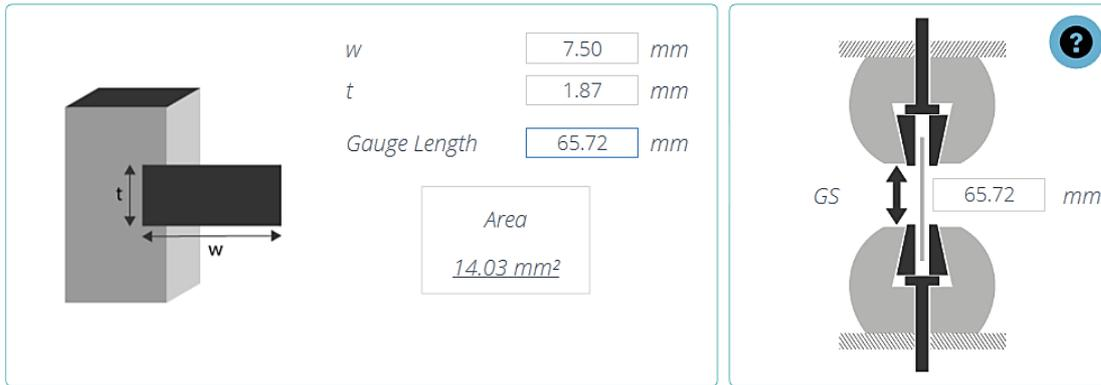
Dans l'exemple ci-dessus, la séparation des poignées est utilisée pour dériver la déformation. La séparation de départ est de 65,72 mm.
