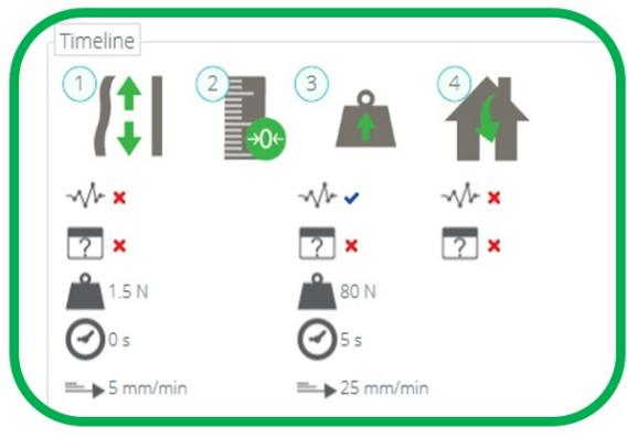
1. Précharge du spécimen (jusqu'à une force de 1.5N à 5mm/min) →
