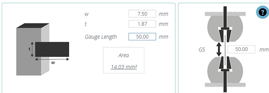
Dans l'exemple ci-dessus, un extensomètre avec une longueur de référence de 50 mm est utilisé.
