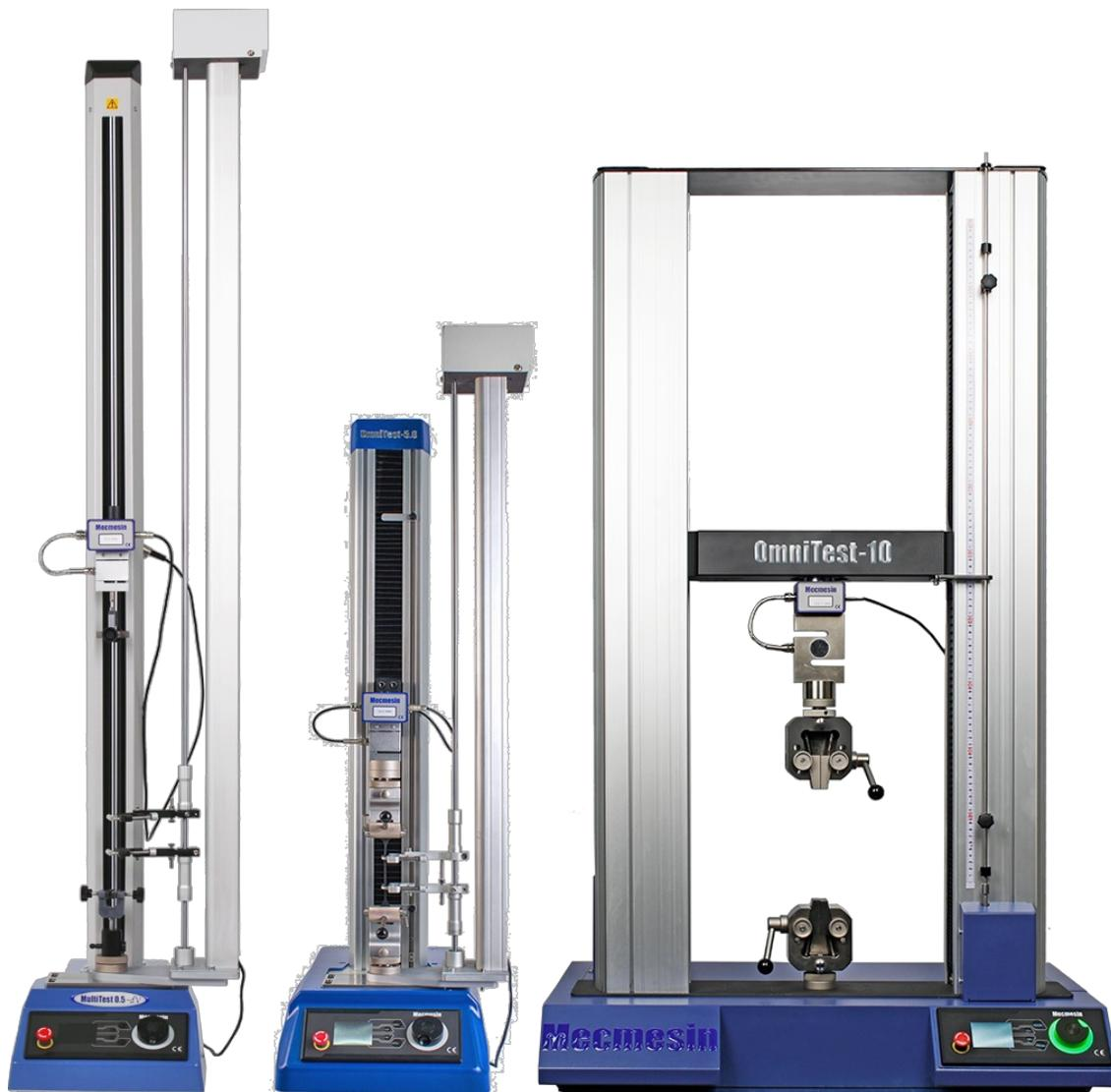
*De gauche à droite, MultiTest-dV avec mode  $dV(u)$  activé, banc d'essai monocolonne OmniTest-5,0 kN et banc d'essai bicolonne OmniTest-10 kN.*
