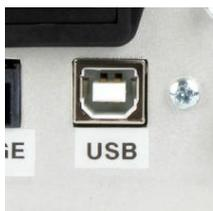
Les appareils suivants se connectent via un câble de communication USB-B vers USB-A - Réf. 351-093 :
