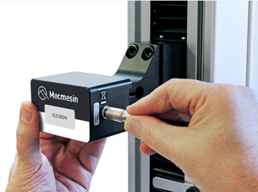
Der Anschluss der Wägezelle wird gelöst, indem der äußere Körper zurückgezogen und die beiden Teile vorsichtig entfernt werden.
