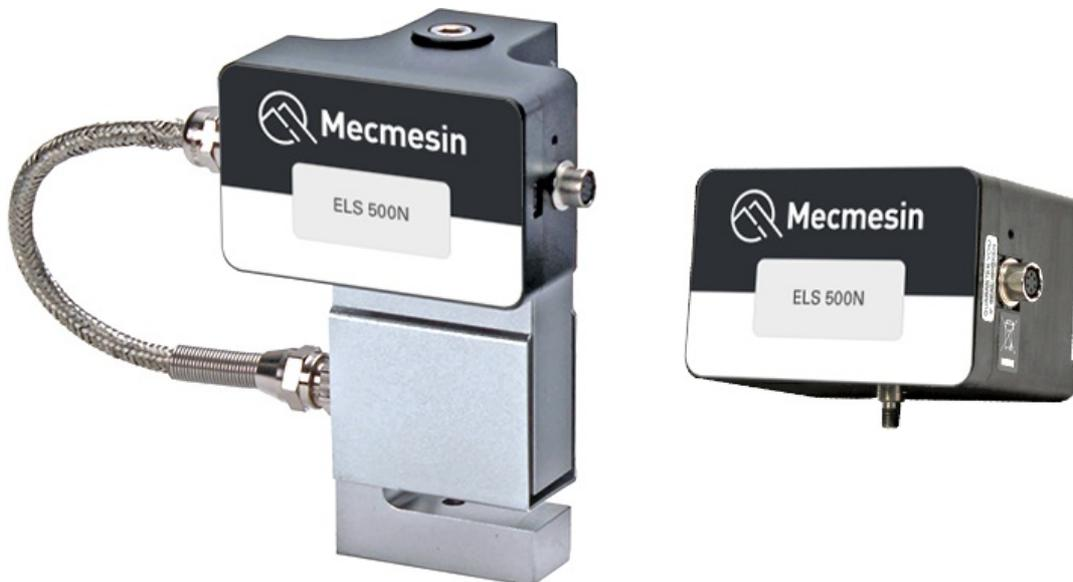
Die Kraftmessdosen der Serie ELS haben ein Gehäuse, das eine interne Kraftmessdose enthält, während die Kraftmessdosen der Serie ELS 'S' eine 'S'-Balken-Kraftmessdose haben, die extern unter dem Gehäuse montiert ist.
