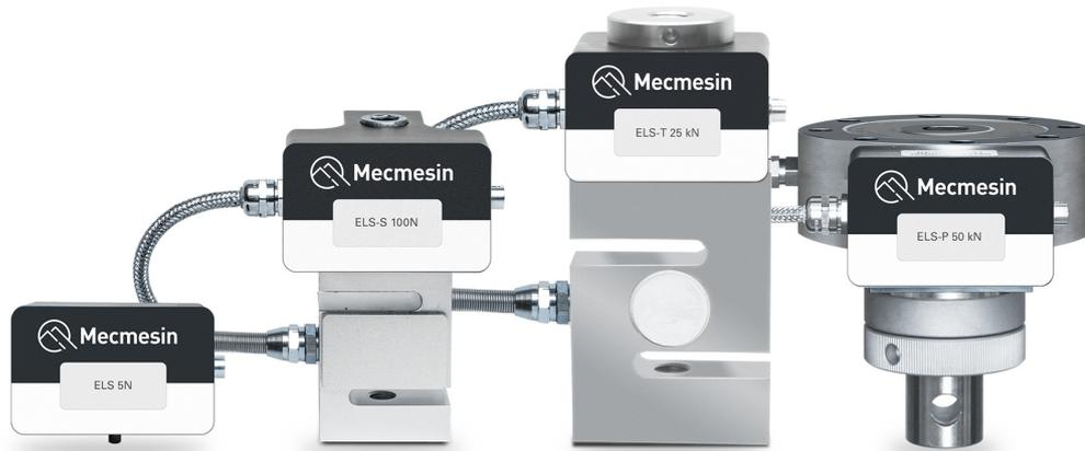
Erweiterte Lastsensoren, kurz **ELS**, sind intelligente Geräte, die zur Erfassung von Lastmesswerten für den OmniTest-Prüfstand verwendet werden. Alle Kalibrierungsinformationen werden auf der einzelnen Kraftmessdose gespeichert, so dass sie von System zu System übertragen werden können und die Kalibrierung ohne Benutzereingabe erfolgt.
