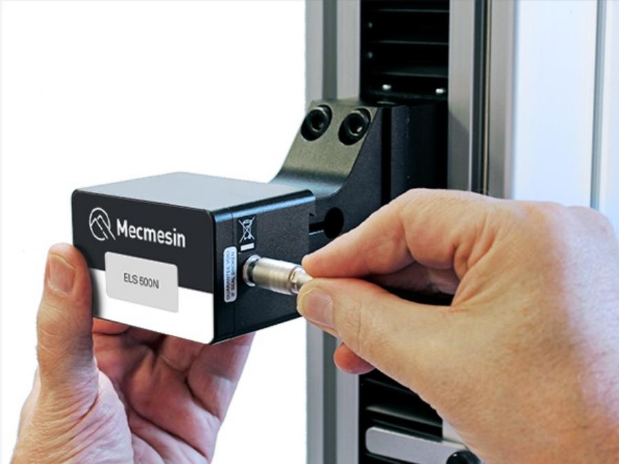
Um die Aktualisierung zu starten, schließen Sie die ELS an das Prüfsystem an und schalten Sie den Prüfstand ein.
