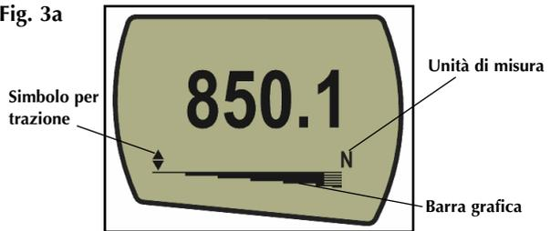
Una piccola barra grafica posta sul display indica all'operatore quanto carico è stato applicato alla cella. Quando il carico applicato supera l'80% del carico massimo consentito, la barra cambia aspetto. Questo consentirà all'operatore di prevenire che vengano applicati carichi eccessivi.
