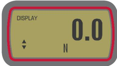
Drücken Sie die **RESET**-Taste, um die gespeicherten Maximalwerte zu löschen, damit das Gerät die Spitzenwerte von dem nächsten Test speichern kann.
