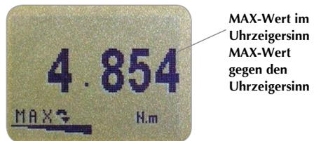
größte während der Messung aufgetretene Drehmoment entgegen dem Uhrzeigersinn zusammen mit dem entsprechenden Symbol angezeigt.
