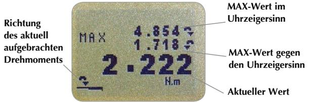
Drücken Sie ein zweites Mal die **MAX**-Taste und das größte während der Messung aufgetretene Drehmoment im Uhrzeigersinn wird zusammen mit dem entsprechenden Symbol angezeigt.
