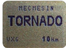
Nach dem Selbsttest wird - vorausgesetzt, dass kein Drehmoment aufgebracht wird - im Display Null angezeigt, da sich TORNADO während des Selbsttests auf Null zurückstellt.
