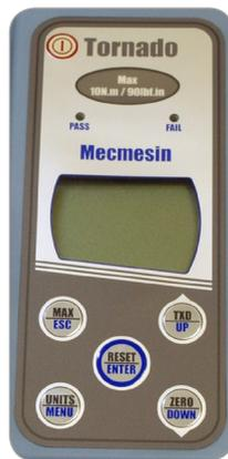
Um das Gerät einzuschalten, drücken Sie die rote
