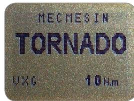
Después del chequeo, sin aplicar carga al instrumento, el display muestra ceros. Esto ocurre porque el Tornado se pone a cero durante el chequeo.
