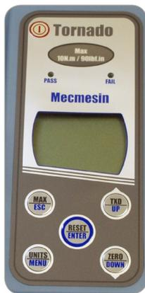
Para poner en marcha el torquímetro apriete la tecla roja
