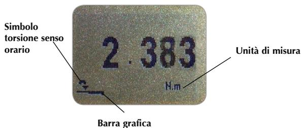
Le torsioni applicate in senso antiorario vengono indicate sul display dell'Orbis con il simbolo mostrato in Fig. 3c. Una piccola barra grafica posta in basso sul display indica all'operatore quanto carico è stato applicato alla cella. Quando il carico applicato supera l'80% del carico massimo consentito, la barra cambia aspetto. Questo consentirà all'operatore di prevenire che vengano applicati carichi eccessivi.
