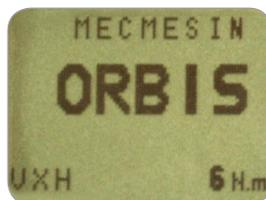
Dopo il Self Test iniziale lo strumento si azzerava automaticamente e al termine il display indicherà zero.
