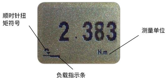
扭矩指示条是用来提醒操作者扭矩传感器的负载程度。在负载接近扭矩传感器最大额定值的过程中，负载量超过额定负载量80%时，指示条更改形状，以此警告操作者防止过载。
