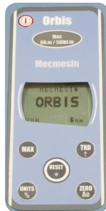
按下红色
