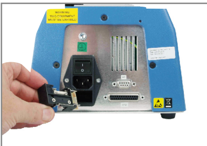
Pour changer la tension de fonctionnement, retirez la cartouche fusible, retournez-la et ré-adaptez
