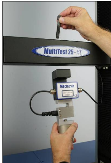
Installation d'un capteur ILC à un banc d'essai double colonne
