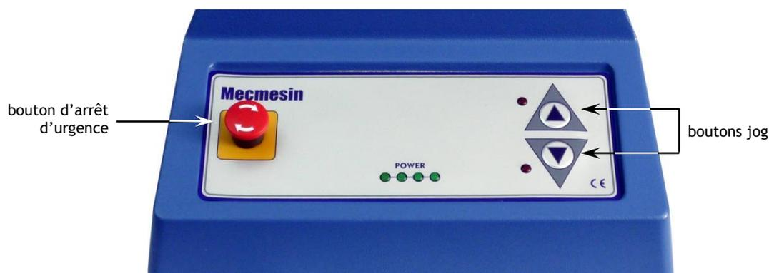
Le panneau de contrôle du MultiTest 2.5-xt. Le Vortex-xt a un bouton d'arrêt d'urgence similaire et des boutons « jog » pour une rotation dans le sens des aiguilles d'une montre et dans le sens inverse.
