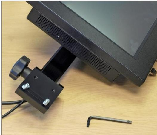
Plaque de fixation et outils pour banc d'essai double colonne
