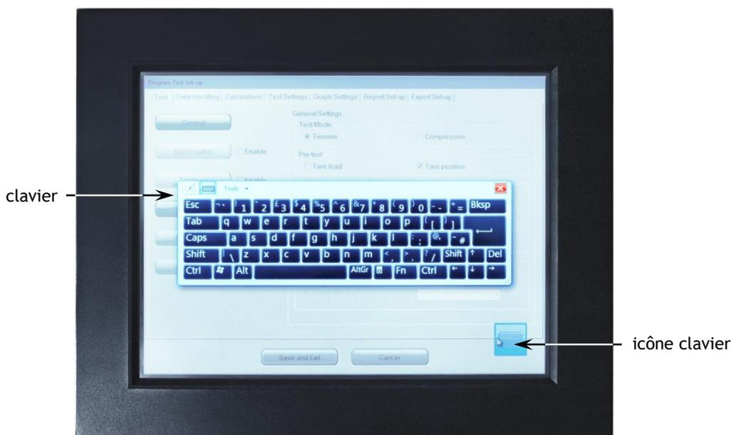
La console *xt* montrant l'icône du clavier virtuel en bas à droite, et le clavier
