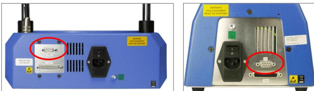
Paneles traseros de un Vortex-xt (izquierda) y MultiTest-xt monocolumna (derecha). Resaltado el conector de 9 pins etiquetado PC.
