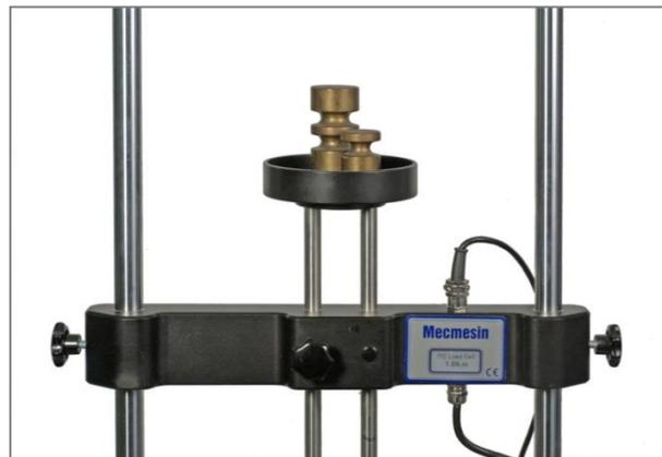
Travesaño de Vortex-xt con pesas en la bandeja del cabezal
