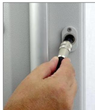
Ensamble mediante cola de milano ...    apretar tornillo de seguridad ...    conectar la célula de carga
