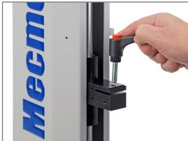
Insertar la palanca del mango ajustable
