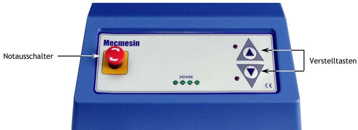
Das vordere Bedienfeld des MultiTest 1-xt. Der Vortex-xt hat einen ähnlichen Notausschalter und rechts- und linksdrehende Verstelltasten.
