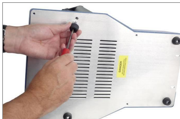
Anbau von GummifüÙen am Bodenteil des Prüfstands
