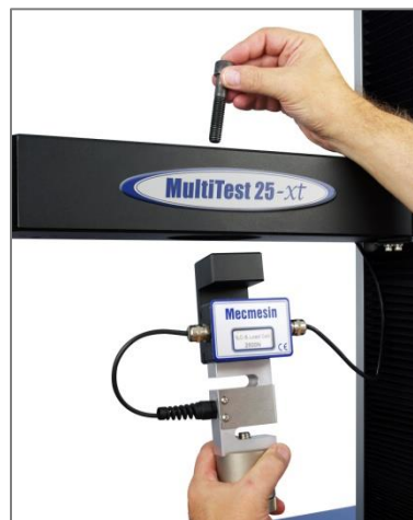
Befestigen von einer Kraftmessdose an einem zweisäuligen Prüfsystem
