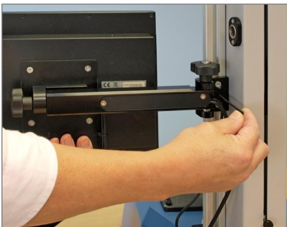
Konsole höher oder niedriger mit Innensechskant stellen
