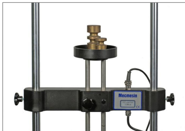
Traverse an einem Vortex-xt mit Gewichte im Lastenträger für Aufliegelast
