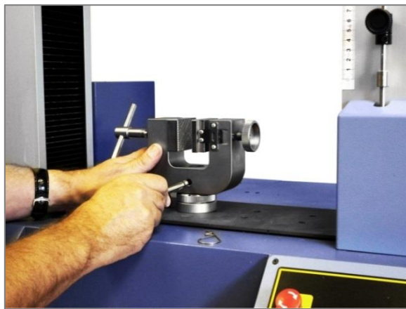
Montage von einem Spannzeug mit QC-Zubehör zum schnellen Auswechseln
