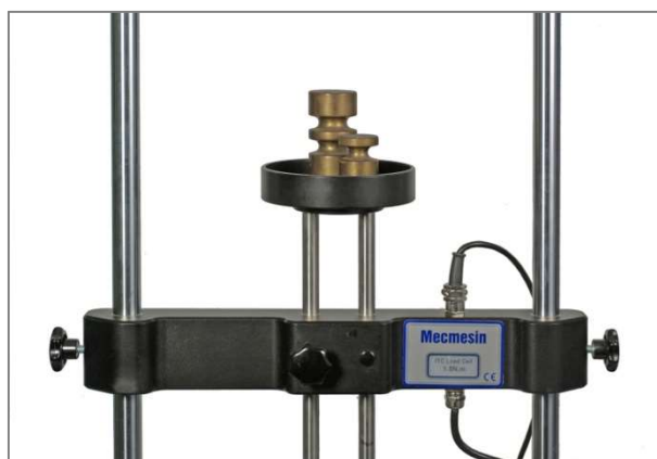
Traverse fixée au Vortex- i avec poids sur la charge axiale
