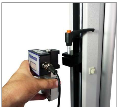
Glisser le capteur sur la platine queue d'aronde ...
