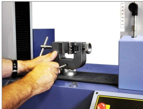
Fixez une pince avec l'adaptateur de montage rapide type QC
