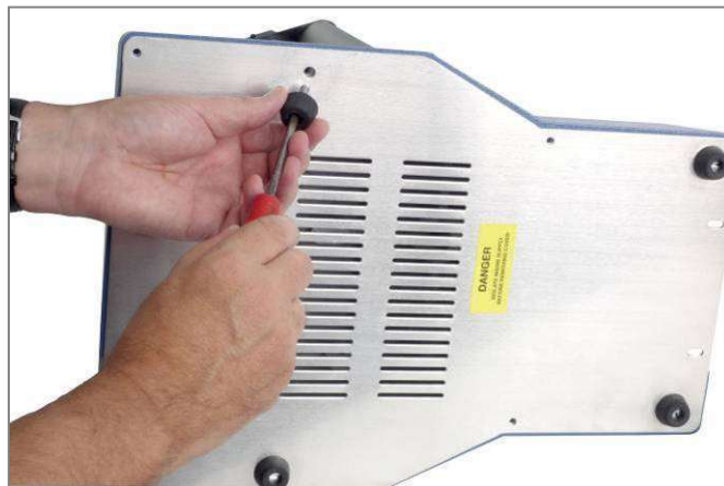
Fixation des pieds en caoutchouc à la base du banc d'essai
