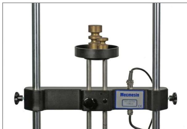
Traverse an einem Vortex-*i* mit Gewichte im Lastenträger für Aufliegelast
