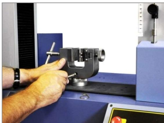
Montage von einem Spannzeug mit QC-Zubehör zum schnellen Auswechseln
