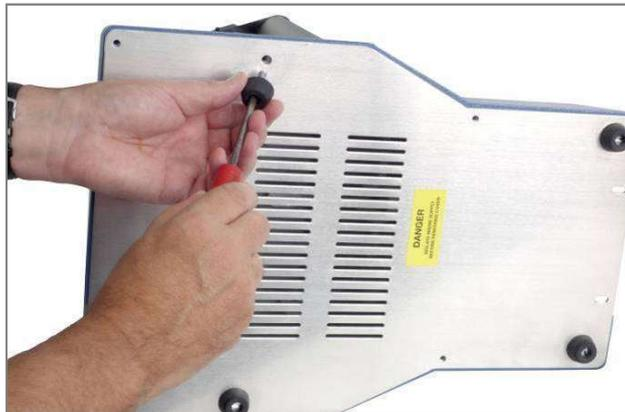
Anbau von Gummifüßen am Bodenteil des Prüfstands
