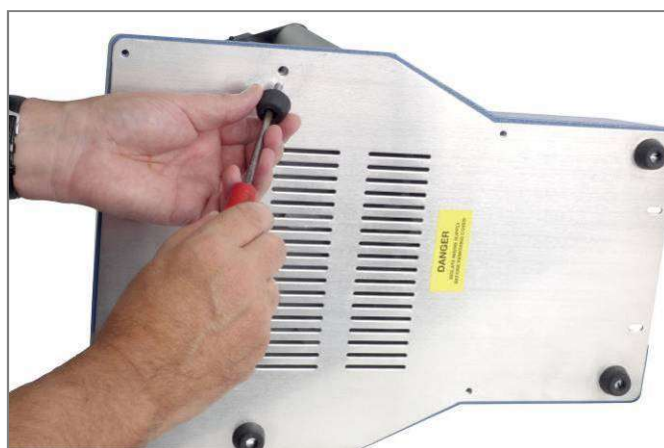
Colocación de los pies de goma en la base del bastidor de ensayo
