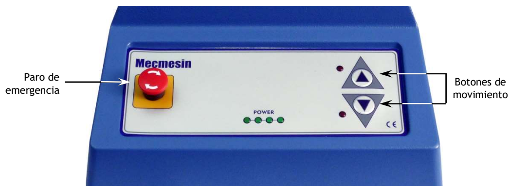
Panel frontal del MultiTest 1- i . El Vortex- i posee un botón similar de paro de emergencia y botones de movimiento para giro en sentido horario y antihorario.
