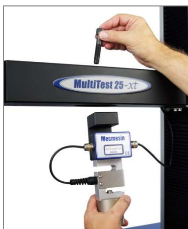
Instalación de célula de carga en bastidor de doble columna
