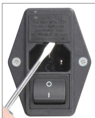
Soulèvement de la cartouche à fusibles
