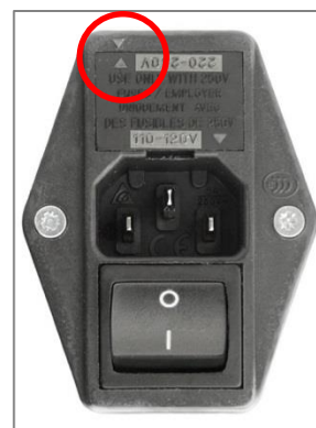
Selector fijado a 220-240 V
