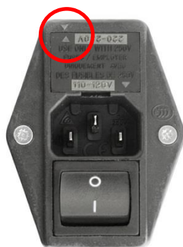
Selettore settato a 220-240 V
