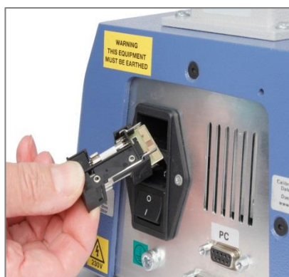
Carrello rimosso per sostituzione fusibili
