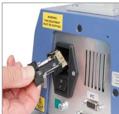
Porta-fusíveis removido para substituir o fusível
