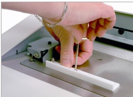
Befestigen Sie die erste Schiene; überdrehen Sie nicht die Schrauben
