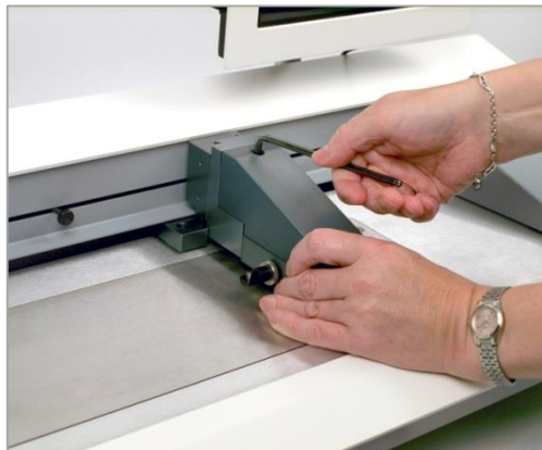
Montage und Demontage der Kraftmessdose
