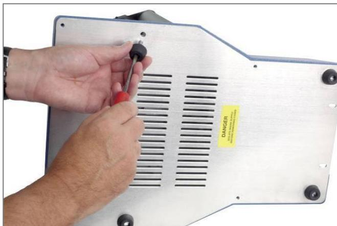
Installation des pieds en caoutchouc sur le socle du banc d'essai
