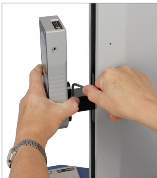
Serrage du support du dynamomètre sur la traverse du banc d'essai
