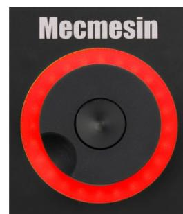
Rouge: *statique*, essai en arrêt ou interrompu
