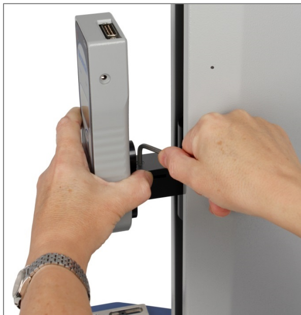
Festziehen des Schwalbenschwanzes bei Montage des Kraftmessgerätes
