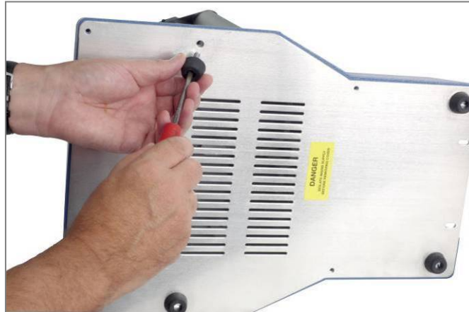
Anbau von Gummifüßen am Bodenblech des Prüfstands
