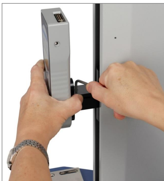
Bloqueando la pletina en el montaje de un dinamómetro.
