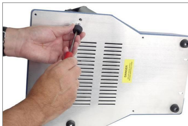
Montar los pies de goma en la base del soporte de ensayo
