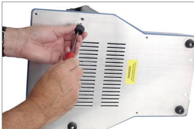
Montage van de rubber voeten op de onderzijde van het statief
