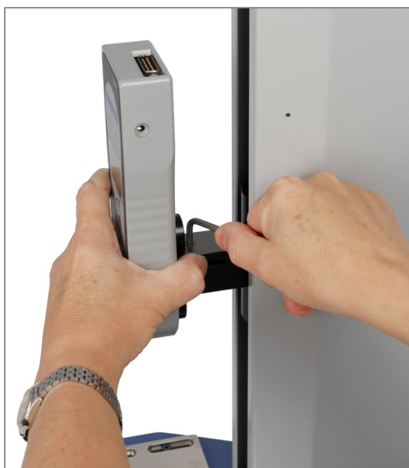
Vastdraaien van het bevestigingsplaatje op de krachtmeter op het montageblok
