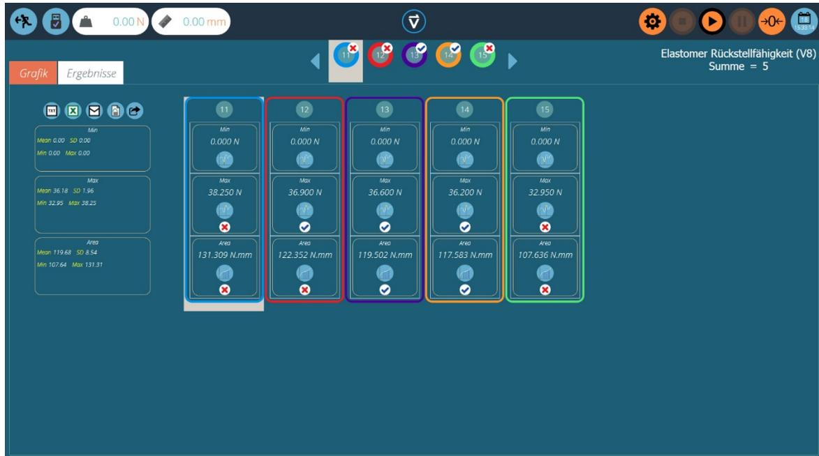
In diesem Beispiel werden sechs Ergebnisse angezeigt. Maximum- und Minimumberechnungen wurden mit Prüflimits verwendet. Vier Proben sind innerhalb des Maximums, aber nur zwei innerhalb des Minimums. Oben zeigt die Proben-Auswahlleiste, dass insgesamt nur zwei Proben bestanden haben, indem Sie innerhalb den akzeptablen Höchst- und Mindestwerten blieben.
