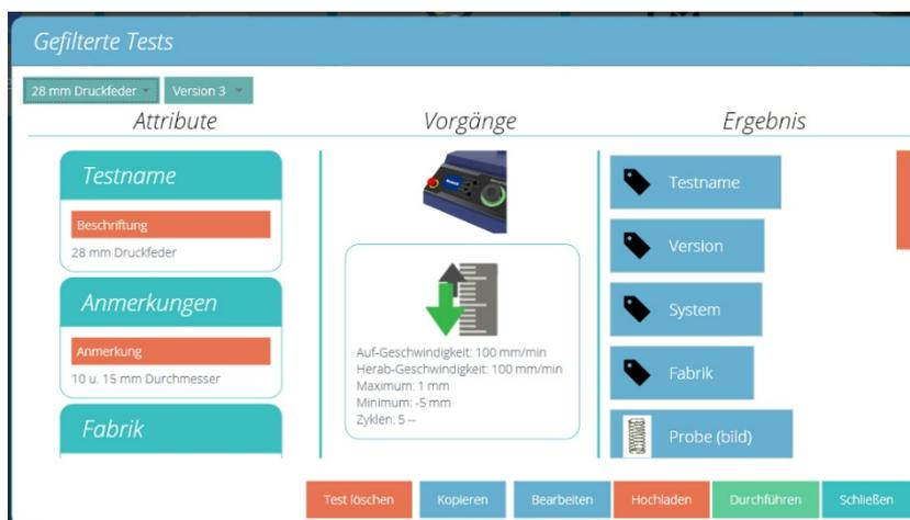
Das Dropdown-Menü zeigt alle verfügbaren Tests. Bei jedem Test werden alle vorherigen Versionen aufgelistet. Wird eine Version ausgewählt, erscheinen die Attribute rechts. Von hier aus, je nach erteilten Berechtigungen, kann der Benutzer:
