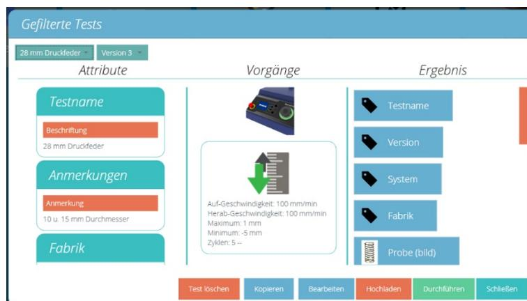
Klicken Sie auf „Hochladen“, um das Testprogramm an den Teststand weiterzuleiten, dann auf „Durchführen“, um die Grafikanzeige zu öffnen und den Test durchzuführen:
