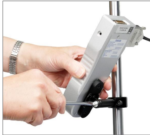
Verstellen des Halterungswinkels
