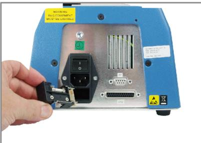
**Para cambiar el voltaje, extraiga el cartucho portafusibles, gírelo y vuélvalo a poner.**
