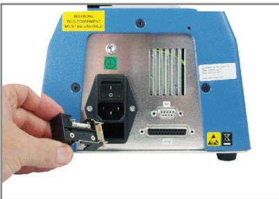
**Per modificare il voltaggio, rimuovere il portafusibili, ruotarlo di 180° e reinserirlo nel suo vano**
