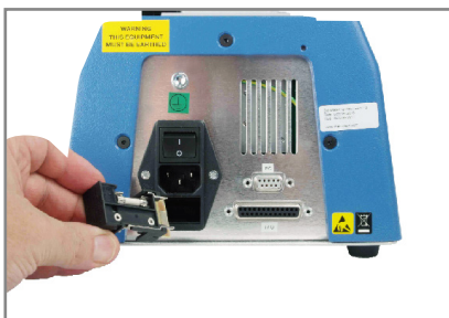
För att ändra driftspänning, ta bort säkringen patronen, vänd på den och åter-fit
