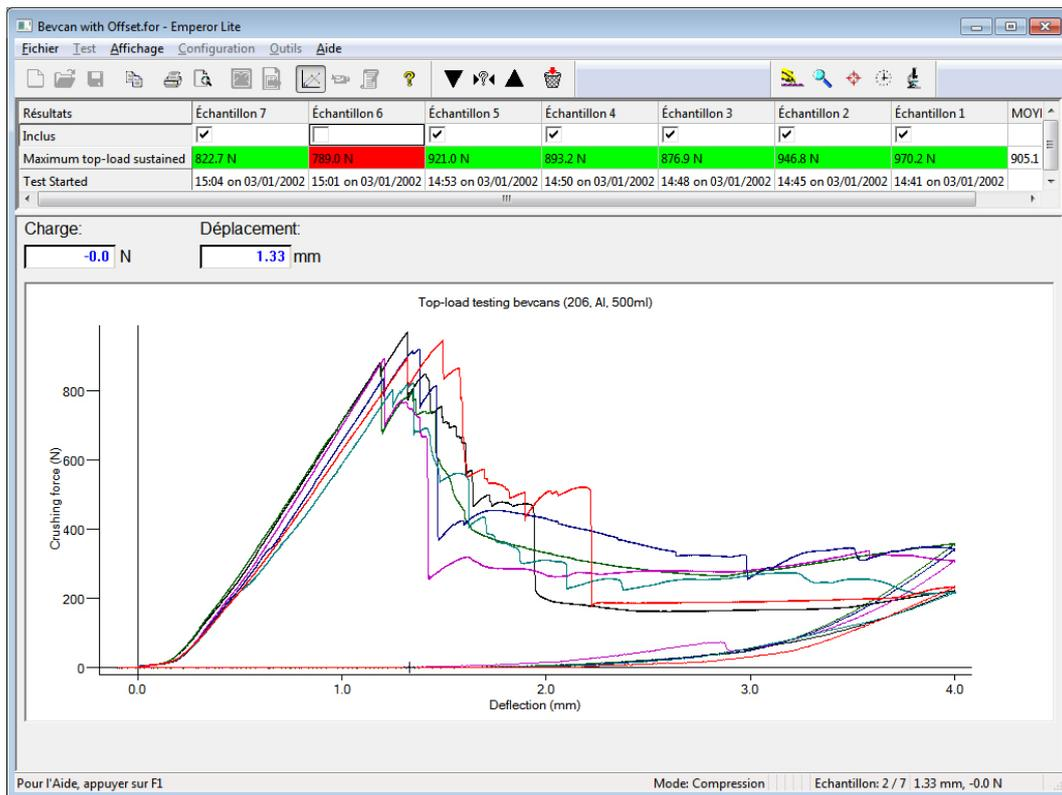
Décalage superposé, l'échantillon 2 (bleu) est sélectionné et aussi (rouge) dans la position affichée en décalage zéro, l'axe des abscisses est agrandi:
