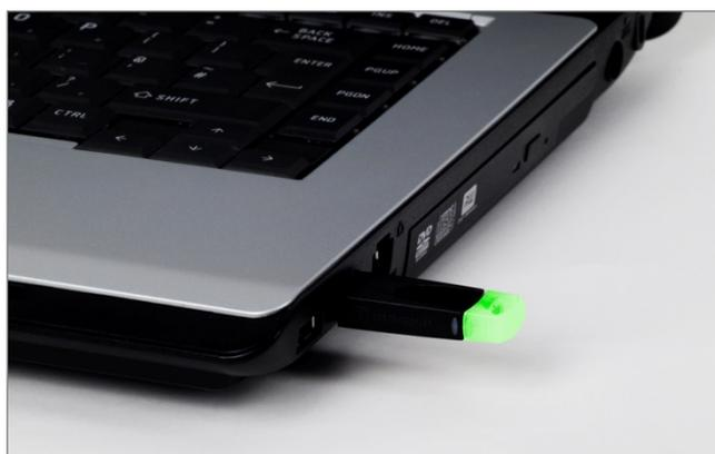
Une clé de licence USB est fournie à chaque achat du logiciel Emperor™ Lite. La clé de licence USB permet à l'utilisateur de communiquer avec l'instrument et d'acquérir les données. Pour établir la connexion, la clé USB doit être présente avant de vous connecter. Elle ne peut pas être insérée une fois que le logiciel est en marche. Insérez la clé avant d'installer le logiciel.
