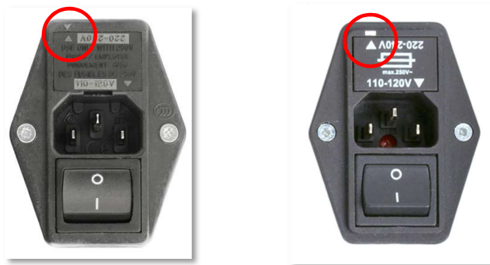
▲ Eine Spannungswähler auf 220-240 V eingestellt
