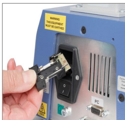
Une fois la cartouche retirée, le fusible peut être remplacé
