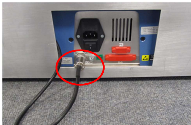
▲ Verkabelung des verriegeltes Schutzkäfigs an Prüfstand angeschlossen
