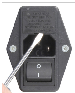
Odstranjevanje nosilca varovalk
