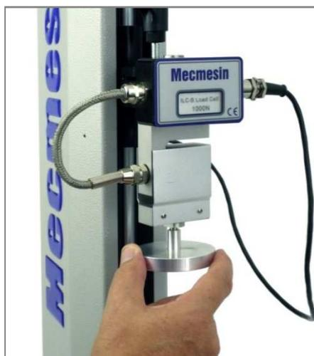
ILC-S e a placa de compressão fixos a um MultiTest 1-*xt*
