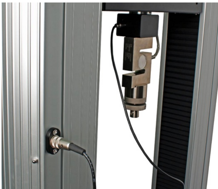
Connexion de l'ELS au banc d'essai.
