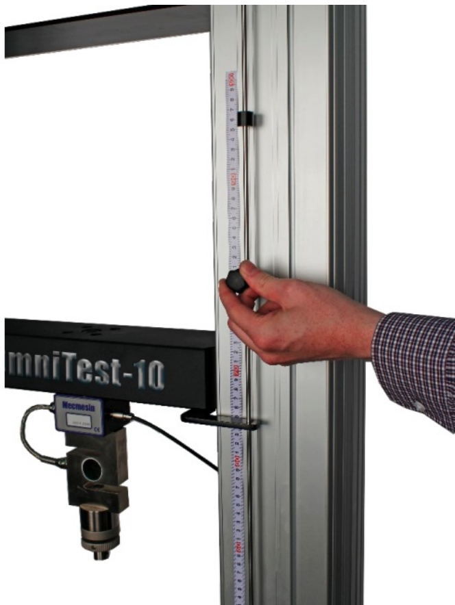
Butée de fin de course sur une OmniTest double-colonne
