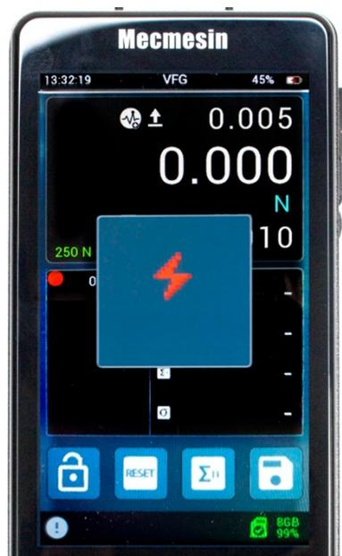
Ihr Vector Instrument verwendet einen relativ leistungsstarken Akku. Das bedeutet, dass es ein leistungsstarkes Ladegerät benötigt, um das Gerät mit einer Nettopladung zu versorgen. Wenn das Netzteil, an das Sie es anschließen, nicht als "PD" gekennzeichnet ist, zeigt das Gerät ein Popup an, um Ihnen mitzuteilen, dass die Leistung des Netzteils nicht ausreicht, um Ihr Gerät zu laden. Berühren Sie einfach das Popup, um es zu löschen.
