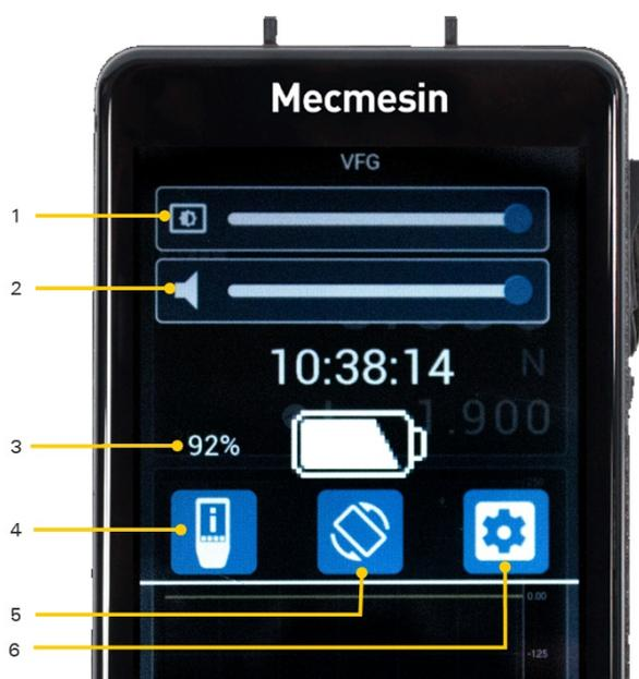
Toccando e tenendo premuta la barra delle informazioni nella parte superiore del display si accede alla barra degli strumenti delle informazioni con le seguenti funzionalità:
