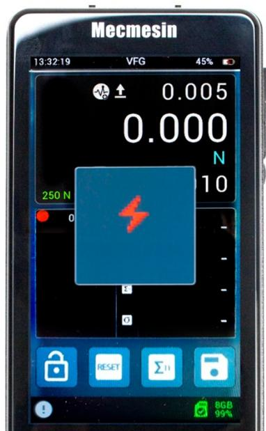
Lo strumento Vector utilizza una batteria ad alta potenza. Ciò significa che è necessario un caricabatterie ad alta potenza per fornire allo strumento una carica positiva netta. Se l'alimentatore a cui lo colleghi non è contrassegnato come "PD", lo strumento mostrerà un popup per informarti che non c'è abbastanza energia nell'alimentatore per caricare il tuo dispositivo. Basta toccare il popup per cancellarlo.
